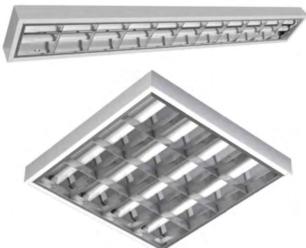
**LUMINÁRIA DE SOBREPOR T8 COM ALETAS DE ALUMÍNIO BRILHANTE****Instalação:** Sobrepor**Corpo:** Aço galvanizado com pintura eletrostática branca**Soquete:** T8/G13 em Policarbonato com trava de segurança e proteção contra aquecimento**Refletor:** Alumínio anodizado importado alto brilho e alta refletância**Aletas:** Alumínio anodizado importado alto brilho e alta refletância**\*ORIENTAR-SE PELA PEÇA PARA RECORTAR O TETO**
