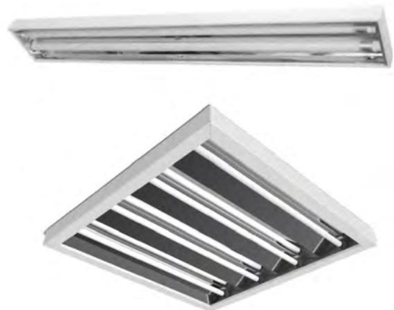
**LUMINÁRIA DE SOBREPOR T8 COM REFLETOR FACETADO EM ALUMÍNIO BRILHANTE****Instalação:** Sobrepor**Corpo:** Aço galvanizado com pintura eletrostática branca**Soquete:** T8/G13 em Policarbonato com trava de segurança e proteção contra aquecimento**Refletor:** Alumínio anodizado importado alto brilho e alta refletância
